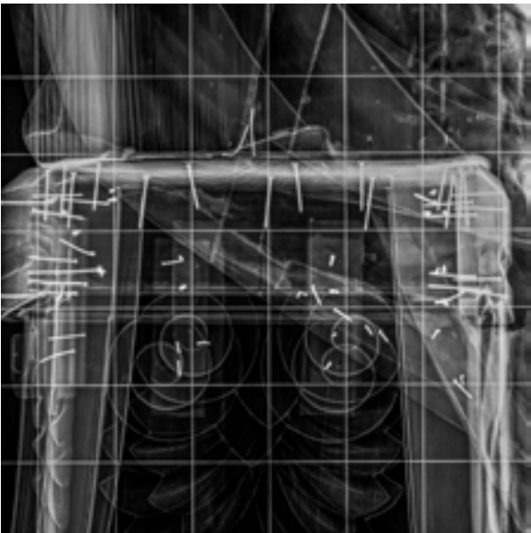
Estudio científico previo.- Radiografía de la silla de San Mateo en la que podemos apreciar los múltiples clavos empleados para reforzar internamente las piezas de madera que conforman el taburete.
