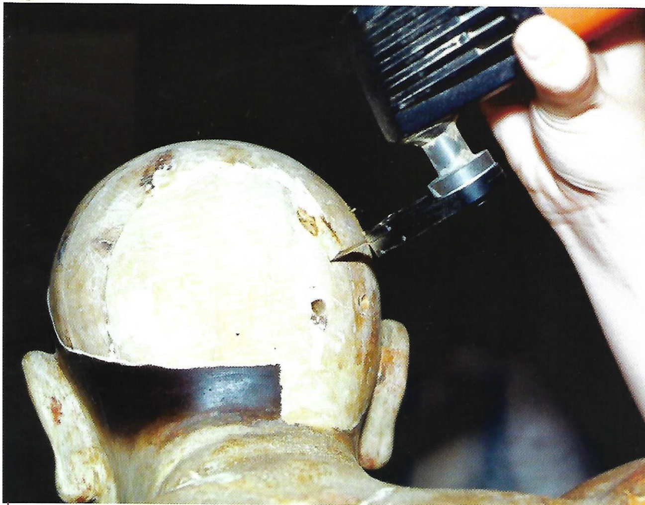
Extracción de muestra de madera para su análisis.
