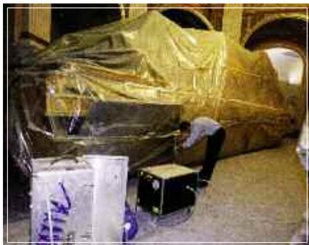
DESINSECTACIÓN DE PASOS PROCESIONALES CON GASES INERTES. BURBUJA DE PLÁSTICO DE BARRERA SARANEX®.
