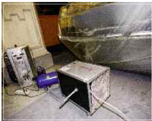
EQUIPO DE DESINSECCIÓN POR GASES INERTES. GENERADOR DE NITRÓGENO, COMPRESOR DE AIRE Y PULMÓN.
