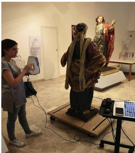
Captura de datos de la Verónica y procesado-alineamiento de los escaneos.
