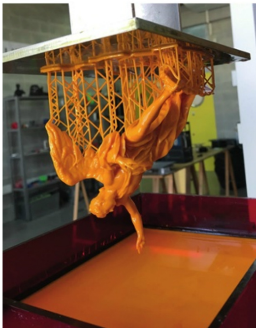
Detalle del proceso de impresión en resina a escala del Ángel de la Oración.
