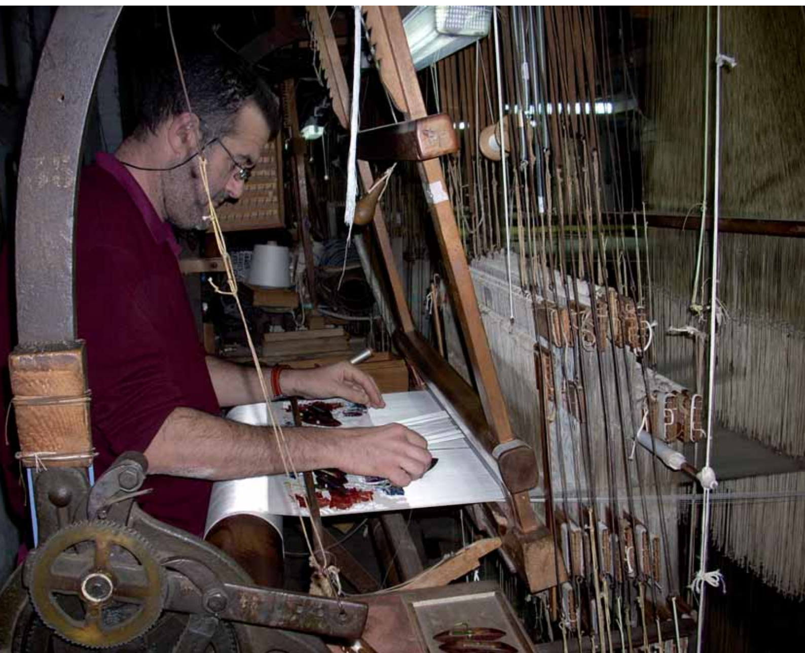
Telares manuales de la fábrica
