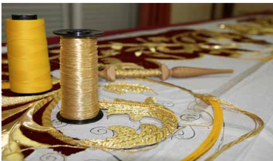
Imagen del proceso de bordado donde se colocan las piezas sobre el dibujo en un soporte de terciopelo. Se puede apreciar el fieltro, la broca con hilo de torzal, un carrete de hilo de muestra y otro del hilo de algodón con el que se tejen y dibujan los distintos motivos.
